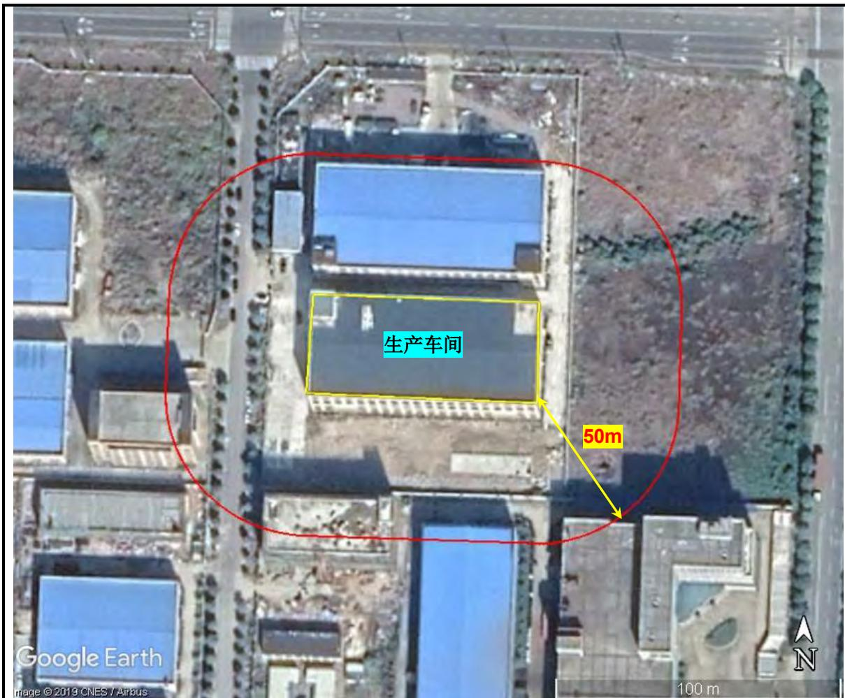
图 7-1 卫生防护距离包络线图
