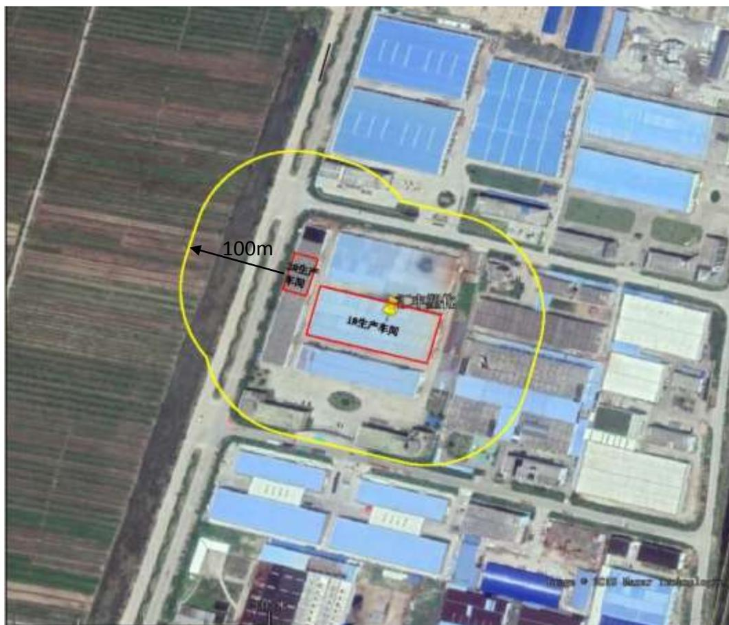
图6.1-7 本项目防护距离包络线图
