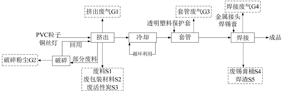
图 4-1 铜线水管灯工艺流程及产污环节图
