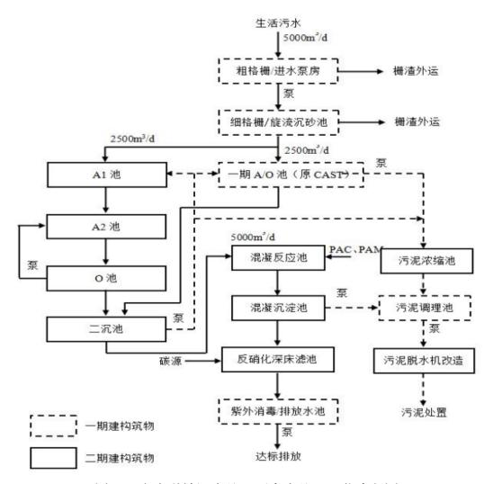
图 4-2 白水洋镇污水处理厂废水处理工艺流程图
