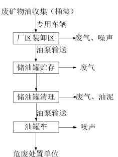
图 2-1 项目废矿物油回收贮运工艺流程和产污环节图
