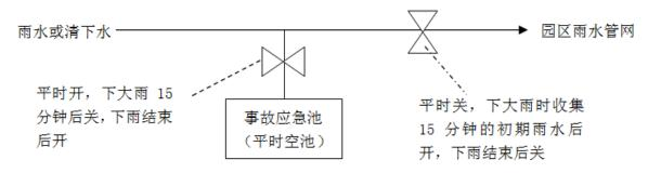
图 1.5-1 企业的事件应急池的应急示意图
