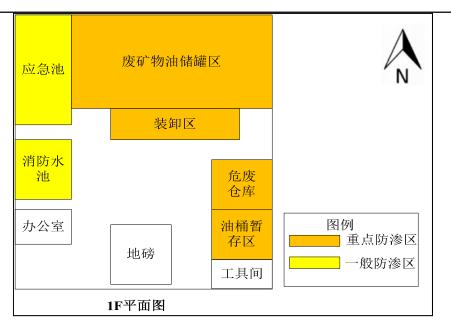
图 4-3 项目地下水污染防控分区图
